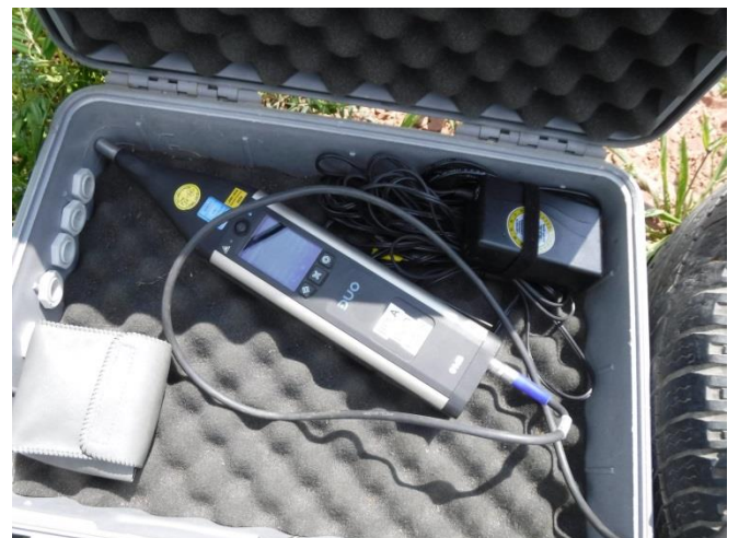
MP 2 – BPlan Buschhölzlein, Bereich Nordost, ca. 2. Bauplatz Messeinrichtung / Schallpegelmessgerät
